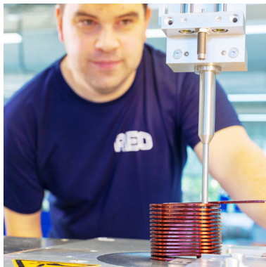
Effiziente Kühlung durch einlagigen Aufbau bei REO EDGE-WINDING
